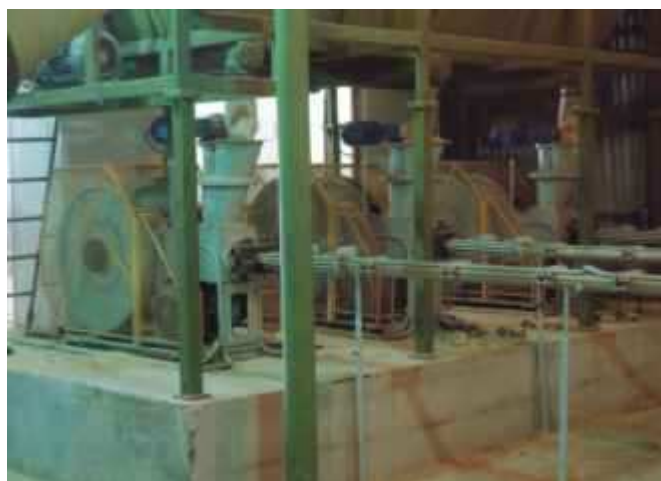
Obr.4 Briketovacia linka vo firme NORBA Prievidza s tromi lisov BZ 50 - 280
