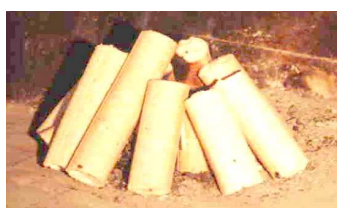
a) valcové brikety bez diery Obr. 2 Reálne tvary brikiet
